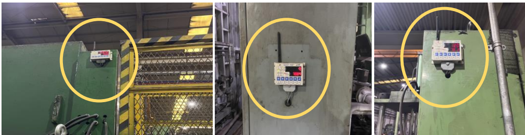
Zigbee 통신 Device 통한 생산 현장 정보 취득
