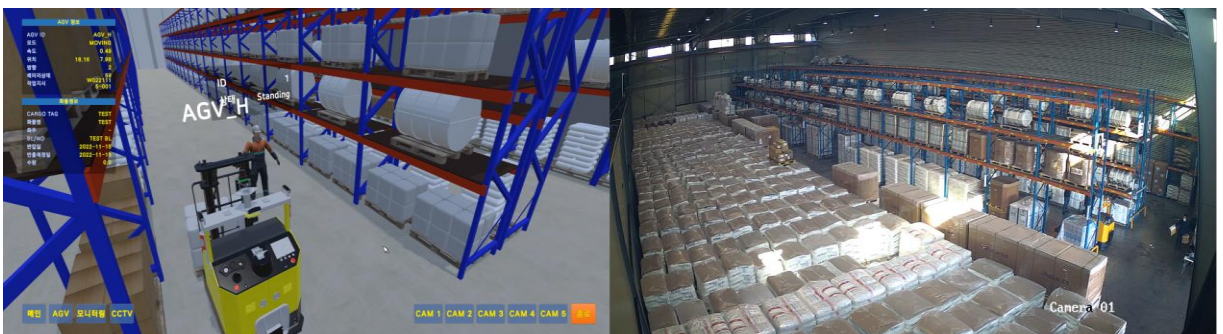
무인지체차(AGV) 및 WMS의 종합 디지털 트윈 시스템 구현
