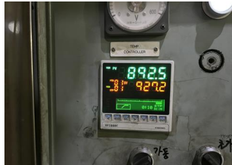
열처리 설비 온도계 설치 및 데이터 수집
